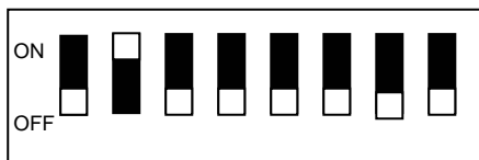
Indirizzamento proiettore dal canale 2 (L'UNICO MINIDIP IN POSIZIONE ON E' QUELLO CONTRASSEGNAO COL 2)
